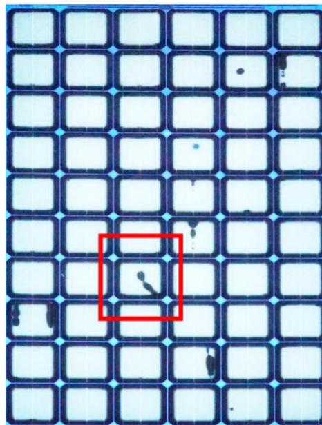
**Figure 10.** UVF imagery of PV module
